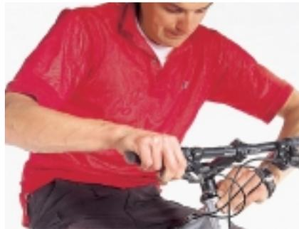
**8** **STEUERSATZ** Ziehen Sie die Vorbauklemmschrauben nach und setzen sich aufs Oberrohr. Die eine Hand zieht die VR-Bremse. Zeigefinger und Daumen der anderen Hand kommen an den Lagerspalt der oberen Steuersatzschale, dieser Unterarm gegen den Lenkergriff. Bewegen Sie nun das Bike nach vorne und hinten. Wenn Ihre Finger eine Bewegung zwischen Gabel und Rahmen erfühlen, muß der Steuersatz nachgestellt werden. Checken Sie auch seine Leichtgängigkeit. Einstellen siehe MB 5/99.
