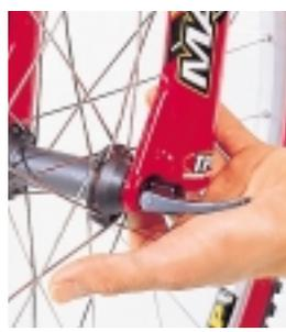
**4** Zur Montage der Laufräder stellen Sie das Rad auf den Boden, damit die Achsen auch richtig in den Ausfallenden sitzen. Stellen Sie die Mutter des **SCHNELLSPANNERS** so ein, daß die Spannbewegung ab der Position schwer verläuft, in der sich der Hebel parallel zur Achse befindet.
